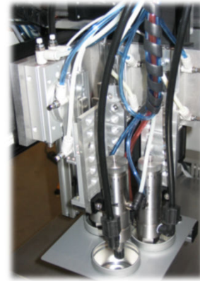
VÁLVULAS EN LAS CUBETAS DE APARCAMIENTO
